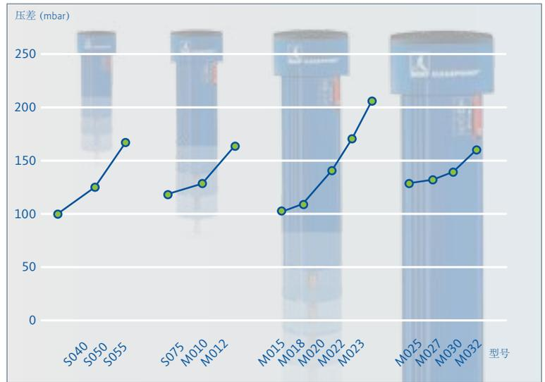
模块化构造的过滤器体积流量经过节能设计，图为不同规格的全新S级过滤器在湿饱和条件下的压差对比。曲线的增长是由各种尺寸过滤器各自不同的长度/直径关系决定的。
